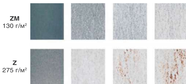
Корозія після 1000 год. у сольовій камері. Протестовано у відповідності з DIN EN ISO 9227.
